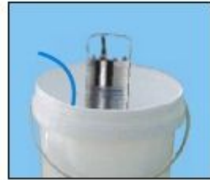
Utilizando la bomba para llenar circuito cerrado
